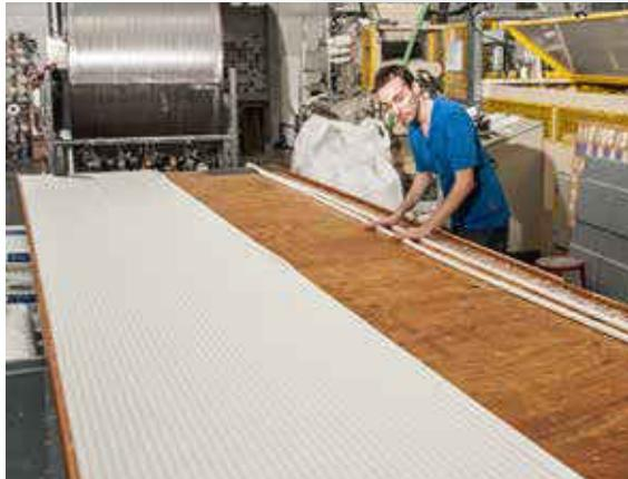
Zuganlage, die stündlich bis zu 5.000 Haushalts- und Opferkerzen herstellen kann, zum anderen eine diskontinuierliche Zugmaschine, auf der Altarkerzenrohlinge bis 60 mm Durchmesser gefertigt werden. Diese werden anschließend in einer Karussell-Tauchanlage auf ihre endgültige Stärke – bis zu 120 mm – gebracht, danach auf die gewünschte Länge geschnitten und in weiteren Arbeitsgängen mit Kopf und Bohrloch versehen.
